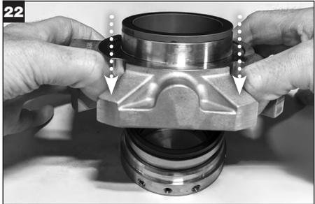
Coloque la brida sobre el conjunto de anillos de bloqueo, con la marca de Chesterton orientada hacia abajo, y alinee la cara del anillo estacionario con la cara del anillo del sello rotativo.
