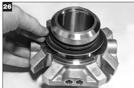
Instale la junta de la caja en el hueco de la brida.
