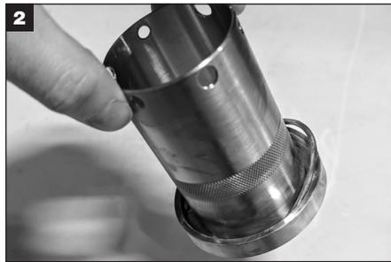
Aplique una película delgada de grasa al O-Ring Rotativo (W) e instálelo en la ranura del diámetro externo del anillo del sello rotativo externo.
