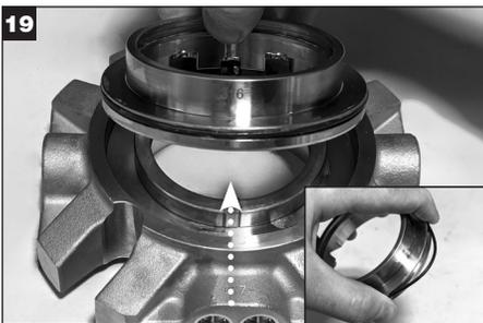
19 Retire el adaptador de la brida. Retire el O-Ring del Adaptador (Z) y deséchelo. Aparte el adaptador.
