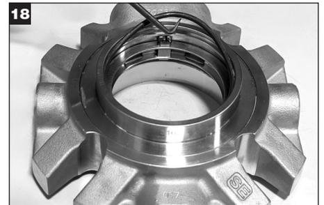
18 Retire el O-Ring Estacionario (X) interno del adaptador y deséchelo.
