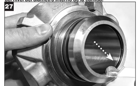
Aplique una película delgada de grasa al O-Ring del Eje (V) e insértelo en la ranura del diámetro interno de la camisa.
