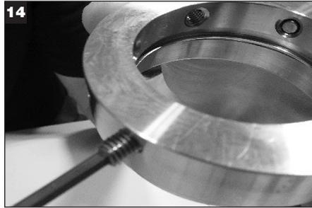
14 **IMPORTANTE:** Los tornillos de fijación no deben sobresalir hacia el diámetro interno del anillo de bloqueo antes de instalarlos en la camisa del sello.
