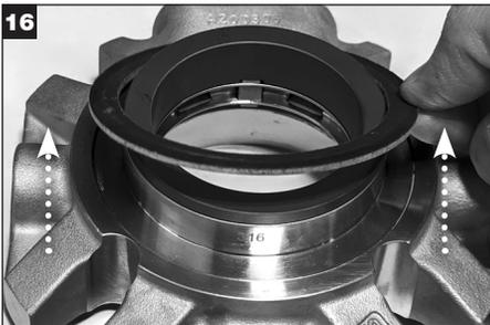
16 Retire la junta del adaptador y deséchela.
