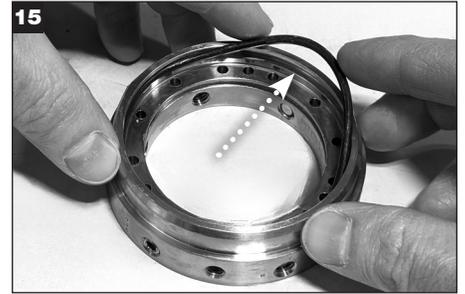
15 Aplique una película delgada de grasa al O-Ring del soporte del anillo de bloqueo (U) e insértelo en la ranura del diámetro interno más grande del anillo de bloqueo.
