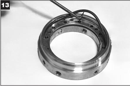
13 Retire el O-Ring del soporte del anillo de bloqueo (U) y deséchelo.
