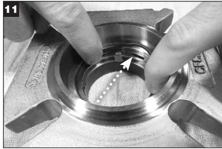
11 Invierta cuidadosamente la brida y colóquela sobre un paño limpio para proteger la superficie del anillo de sellado interno. Aplique una película delgada de grasa al O-Ring Estacionario (X) restante e instálelo en la ranura del diámetro interno en la brida.
