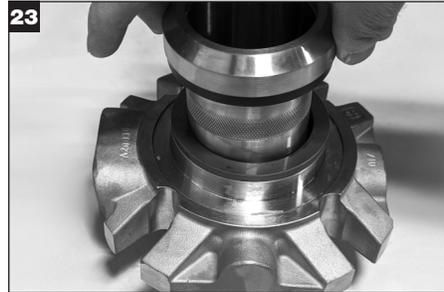
Invierta el conjunto de la camisa, sujetando alrededor del diámetro externo del conjunto de la camisa y deslícelo sobre la brida y los conjuntos de anillos de bloqueo. **IMPORTANTE: La muesca en el extremo de la camisa deberá alinearse con los tres puntos verticales en el diámetro externo del anillo de bloqueo cuando se haya instalado correctamente.**
